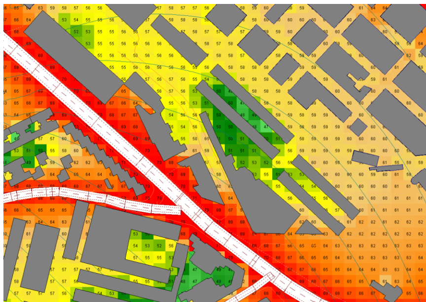
Cálculo de malla cuya interpolación permite obtener los mapas de niveles sonoros (isófonas)
