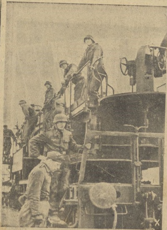
Un cañón alemán de largo alcance de la Artillería alemana montado sobre los vagones de un ferrocarril. Por medio de estos cañones pueden los alemanes disparar desde la costa francesa a la costa inglesa.
