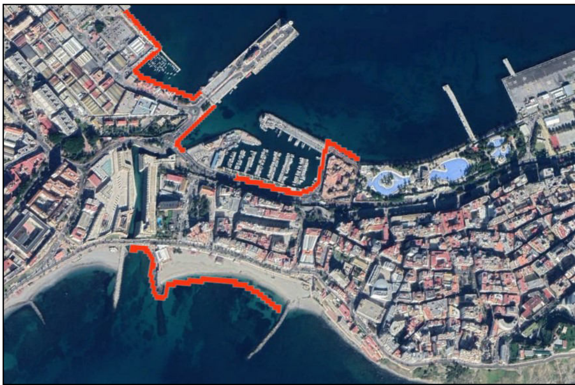
Ilustración 23: Zonas potencialmente inundables por fenómenos costeros
